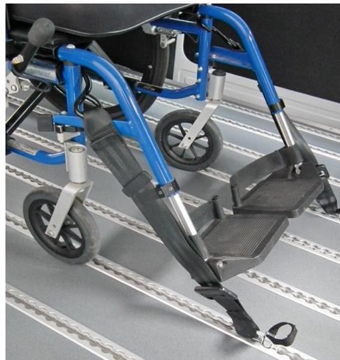
Die hinteren 2 Gurte sind mit selbstspannenden Retraktoren und Handrad bestückt und erlauben so die sichere, feste Abspannung des Rollstuhls nach allen Seiten.
