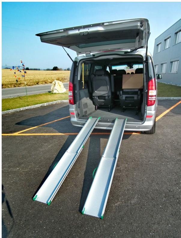
Die teleskopischen Schienen können bequem an **Haltegriffen** getragen werden und sind mit **Antirutschprägung** versehen. Lieferbar in den Längen von **2.0, 2.5 Meter oder 3 Meter**.
