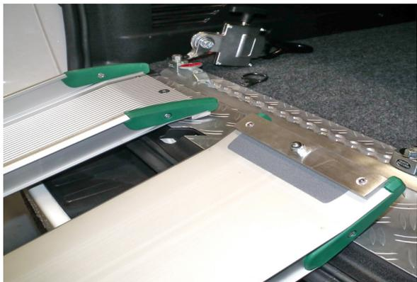
Auf Wunsch wird ein **Zapfen** in die Schiene eingebracht und die Heckschwelle wird verstärkt. So können die Schienen nicht verrutschen.
