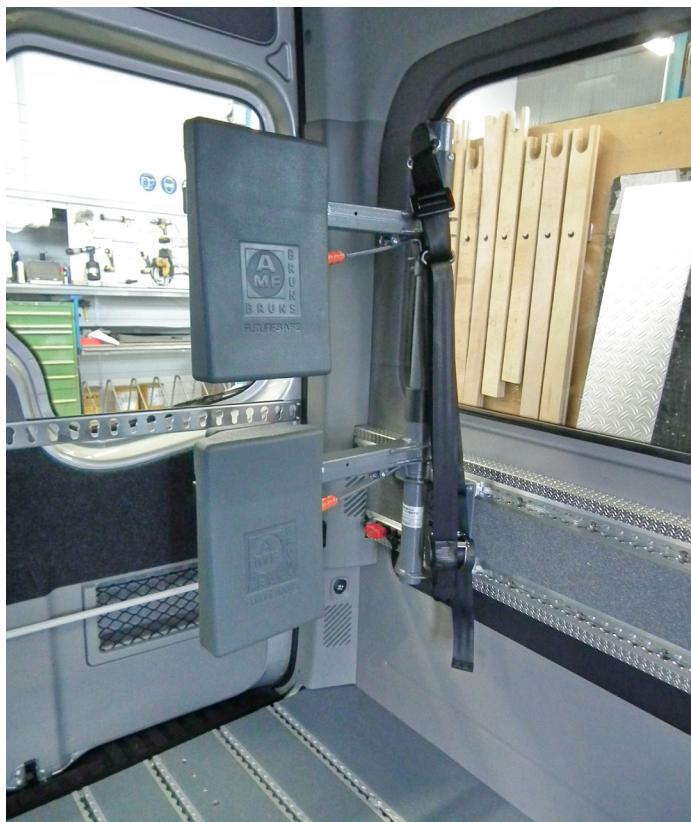
Kopfstütze und Rückenlehne für Rollstuhlplatz ausgeklappt
