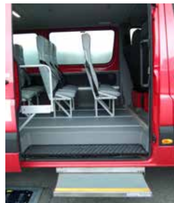
Un marchepied linéaire et une rambarde augmentent la sécurité pour entrer et sortir.
